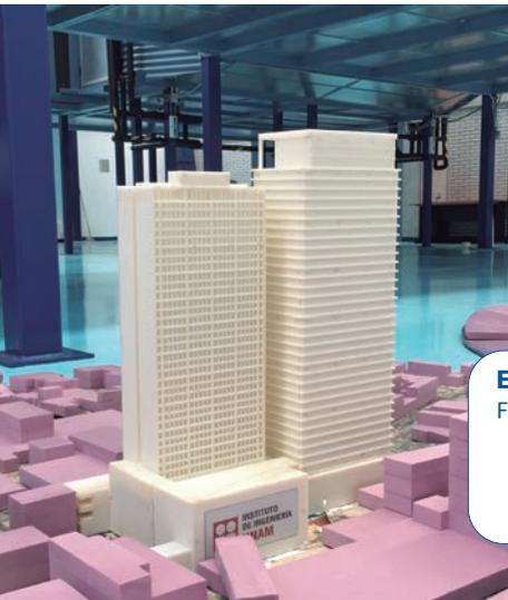
*En proyectos de grandes dimensiones y gran altura el estudio de viento nos ayuda a diseñar toda la envolvente del edificio y a poder dimensionar adecuadamente las fuerzas que van actuar en la fachada para evitar que tengamos desprendimientos o que se sobredimensione la estructura.*
